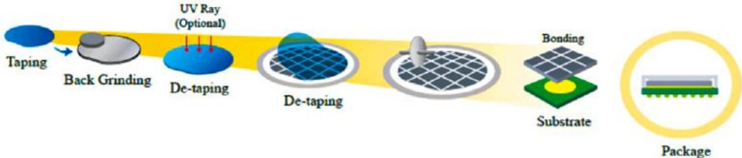
UV解黏膠帶應用於:玻璃裁切保護、拋光、研磨、顯影、切割製程，小面積銅箔及PCB切割製程。
